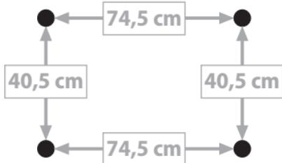
Angaben von Bohrlochmitte zu Bohrlochmitte // Measurements from centre of one drill hole to the other // Distances entre les centres des trous de perçage // Specifiche da centro a centro dei due fori // Indicaciones del centro de un taladro al centro del otro // Afstanden van middelpunt boorgat tot middelpunt boorgat
